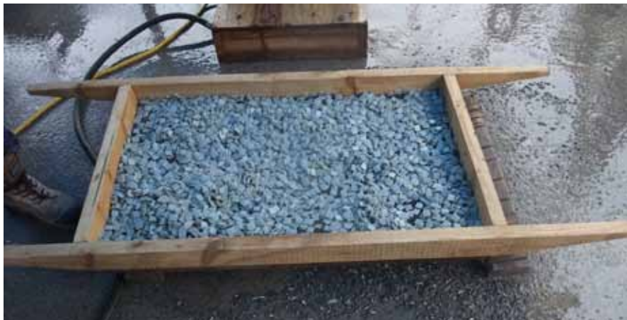
左上圖：老舊瓷磚浸泡在水中，方便之後將其從基層上剝離；右上圖：浸泡後的瓷磚塊放入轉鼓，實現剝離；下圖，從左至右：轉鼓內的瓷磚；將清潔打磨後的瓷磚與新的瓷磚混合在一起後（補償損失部分），放入袋中；剝離干淨後的瓷磚從轉鼓中倒出，放置在篩網上
