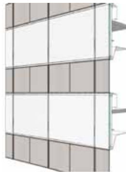
第八步：安裝USP幕牆和手邊構件
